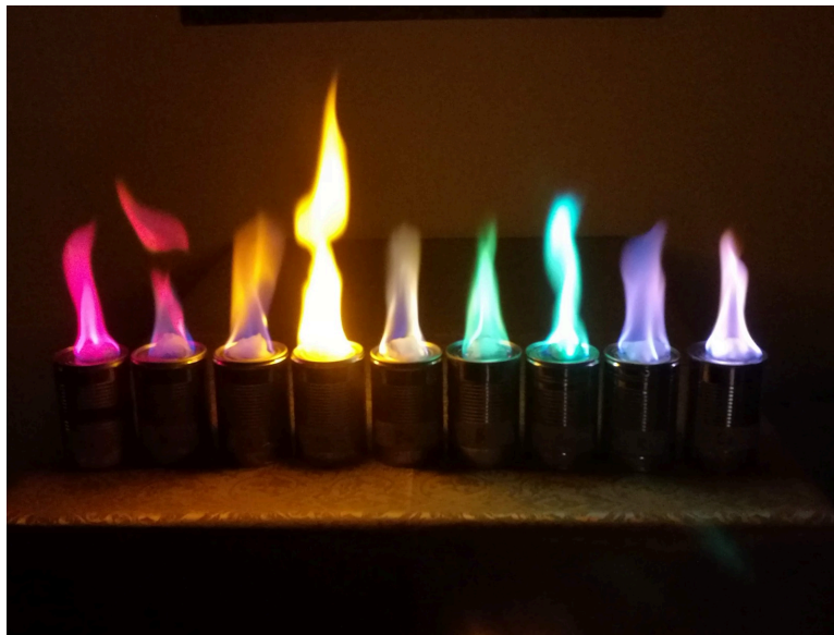
金属塩のメタノール溶液の炎。左から Li・Sr・Ca・Na・Ba・B（ホウ酸トリメチル）・Cu・Cs・K
